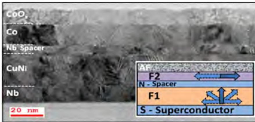
Figura 1.17: Imagem de TEM da válvula de *spin* supercondutora  $Nb/Cu_{41}Ni_{59}/nc - Nb/Co/CoO_x$  e desenho da mesma. As setas indicam a possível orientação dos momentos magnéticos nas camadas FM [5].
